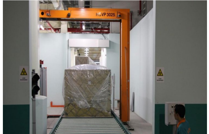
Hình 34: Máy soi chiếu tự động X-Ray có thể xử lý hàng hóa chiều cao 4,5m và chiều rộng 3,2m trong khoảng 2 phút
